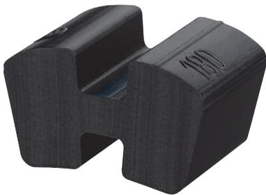
Les paquets de l'accouplement N-EUPEX sont soumis à une sollicitation de pression. Ce qui lui donne une caractéristique de ressort de torsion progressive. En cas de destruction des paquets, un contact métallique s'opère entre les parties métalliques. Ainsi, le couple continue à être transmis en mode dégradé pour une courte période.
